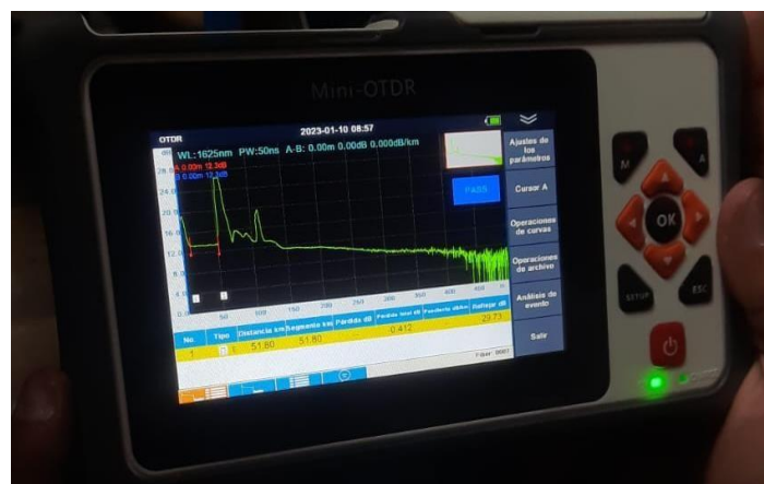
Figura 4. Medición mini OTDR - 51,80 metros
