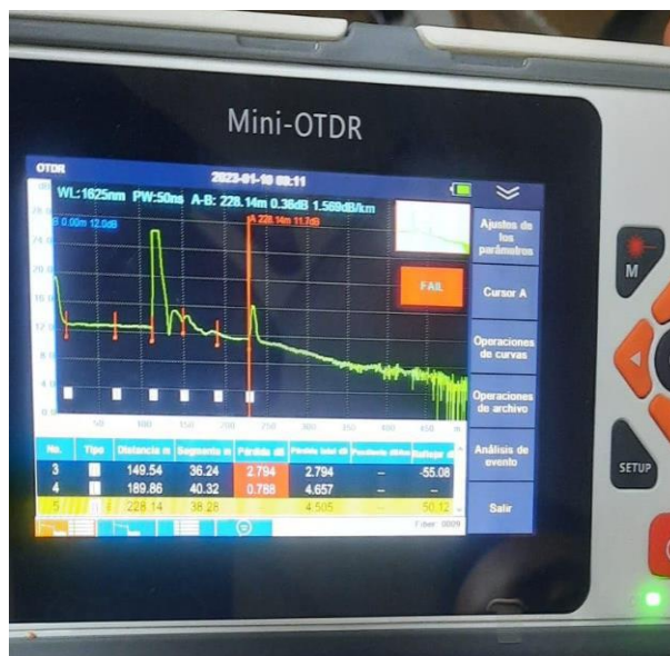
Figura 6. Medición mini OTDR - 228 metros
