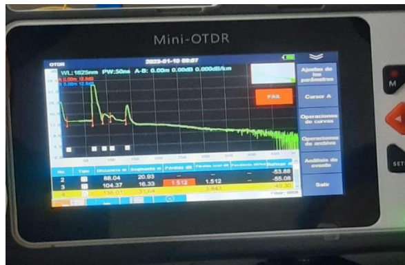
Figura 5. Medición mini OTDR - 131 metros.
